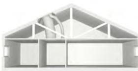
Установка светового туннеля VELUX в санузле с комплектом для вентиляции (при наличии нежилого чердака).
